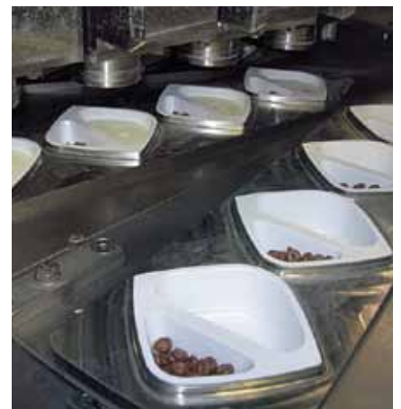
Intérieur de l'installation de remplissage avec balance multi-têtes intégrée et doseur de yaourt
