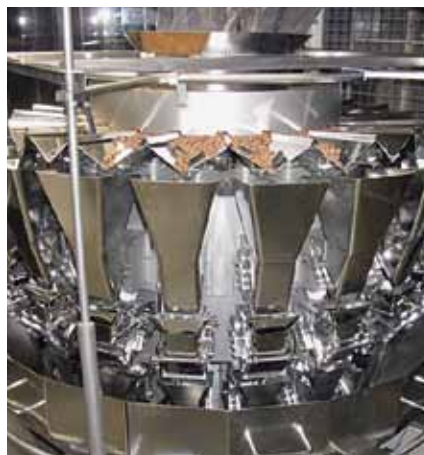
Balance multi-têtes qui permet un dosage du poids précis des crispies
