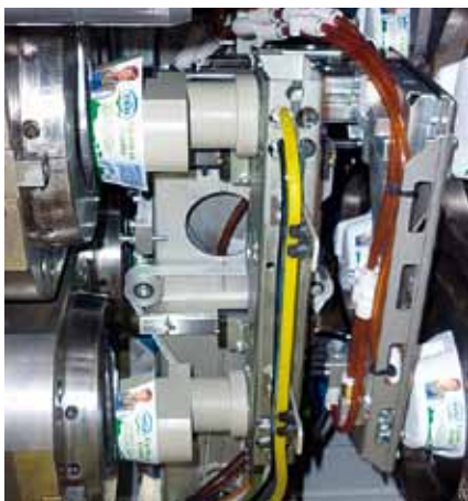
Placement de l'étiquette IML et enlèvement du pot deux compartiments fini
