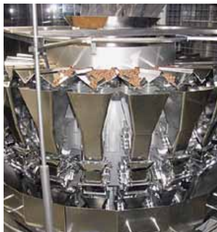
Multikopfwaage, die eine gewichtsgenaue Dosierung der Krispies ermöglicht
