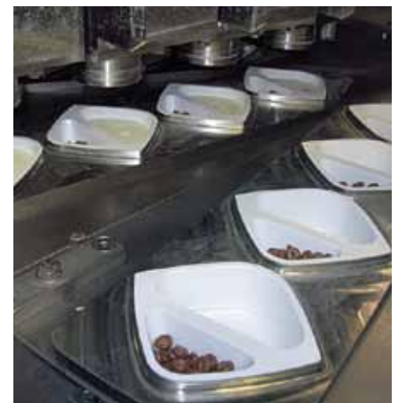
Maschineninnenraum der Abfüllanlage mit integrierter Multikopfwaage und Joghurtdoseur
